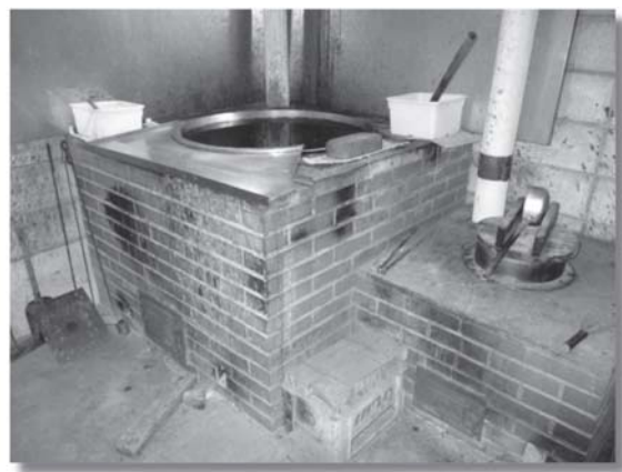
写真5 秋田しよつつる製造元の火入れ釜
